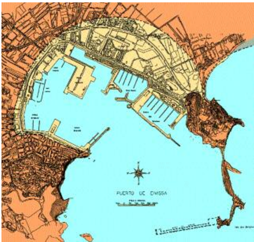
Comparación de la ribera del antiguo puerto de Eivissa según el plano de la lámina 16 del Atlas Marítimo de España de 1787 con la ribera actual señalando los terrenos ganados al mar. (DS)
