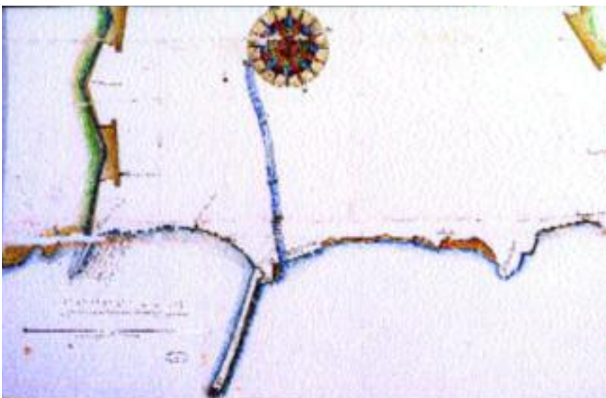
Plano de Antonio Saura con la carta de 1613 del virrey Coloma explicando el desvío de la Riera con propuesta de escollerado en Contramuelle para evitar aterramientos. (CP)
