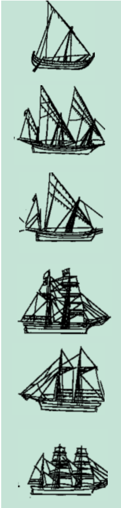
Siluetas de algunos barcos de vela que fueron tradicionales en el comercio de Baleares. De arriba a abajo: tartana; jabeque; Ilaüt viatger; bergantín-corbeta; pailebote; brik-barca o barca. (XP)
