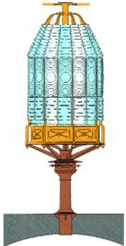
Primitives òptiques de perfil Fresnel giratòries utilitzades als fars del Pla de 1847. (CC)
