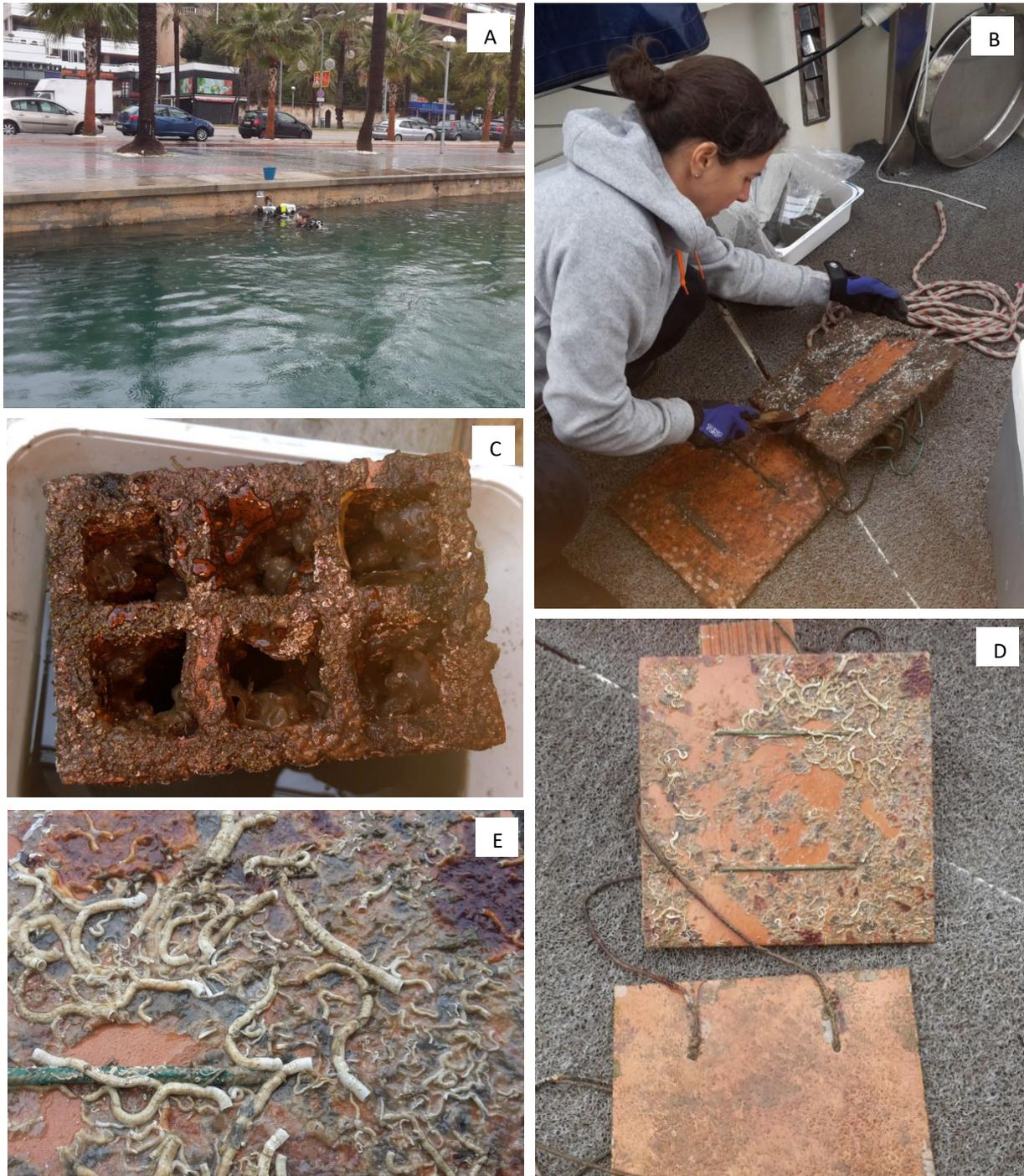
Fig. 7. Fotografías del muestro de invierno (25 y 26 de julio 2017) A. Buceadores recogiendo las baldosas en el Puerto de Palma. B. Toma de las muestras de bio-fouling en el barco. C. Detalle de los organismos sobre las superficies de los ladrillos. D. Baldosas cubiertas en distinto grado por organismos. E. Detalle de los tubos de serpúlidos (Annelida), y esponjas sobre la superficie de una baldosa.
