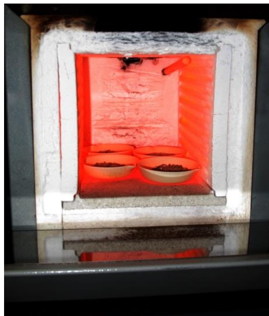
Forn mufla per a la incineració de les mostres.
