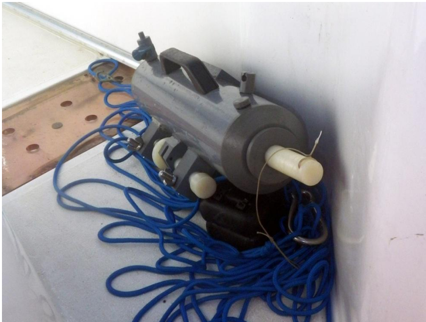
Botella oceanogràfica Nisrin per a l'obtenció de mostres a diferents profunditats.
