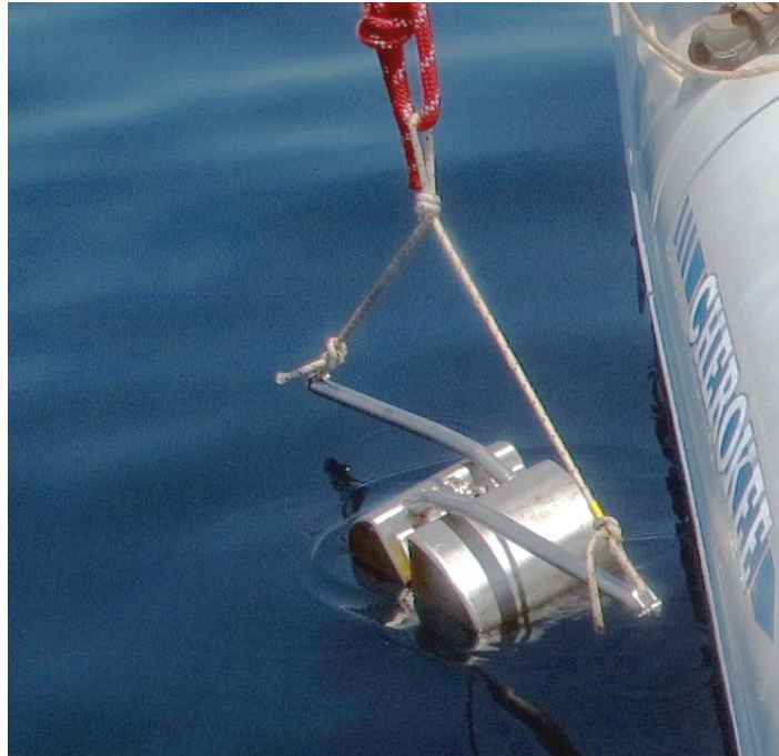
Draga Van-Veen de doble cullera utilitzada per a la presa de mostres de sediment.
