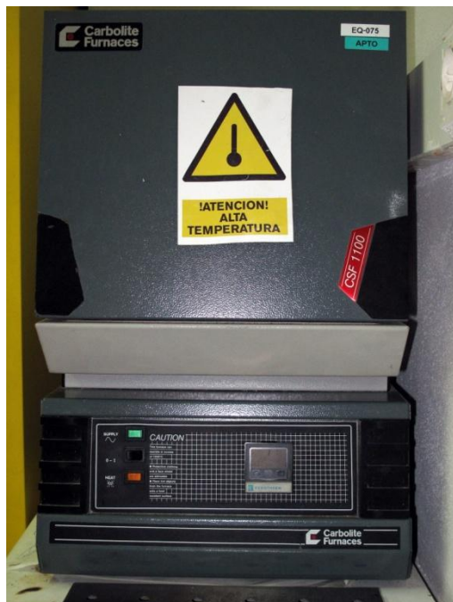
Forn mufla per a la incineració de les mostres.
