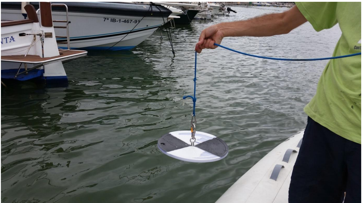
Disc de Secchi utilitzat per a la mesura de la transparència de la columna d'aigua.
