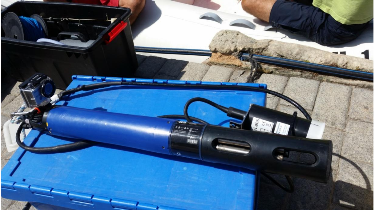
Sonda multiparamètrica amb fluoròmetre i càmera de vídeo.
