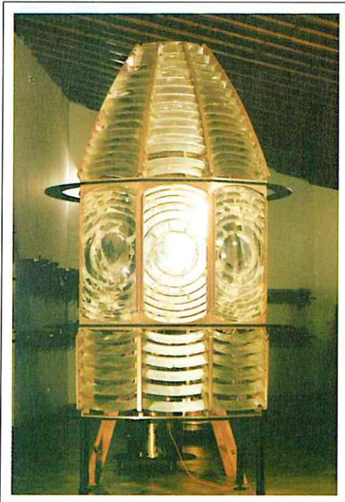
3.1.- Primitiva óptica del faro de n'Ensiola que prestó servicio con la primera instalación del Plan de 1847, entre 1870 y 1927. Giraba sobre una instalación de galets (rodillos).
