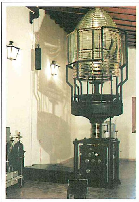
2.6.- Máquina de rotación, basamento de mercurio y óptica procedentes del faro de Capdepera. En servicio entre 1924 y 1961.
