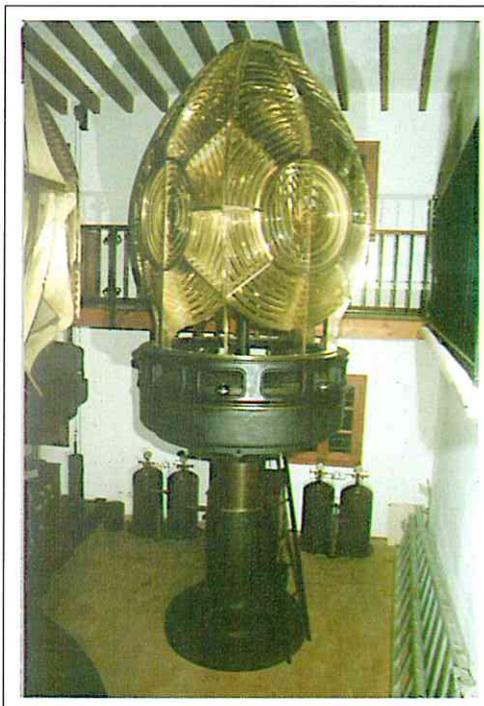
2.9.- Basamento, cuba de mercurio, máquina de rotación y óptica giratoria Chance que prestaron servicio en el faro de Llebeig de 1910 a 1973. Este basamento fue trasladado de la Isla Dragonera a Porto Pi mediante helicópteros de la Armada Americana que lo llevaron suspendido.
