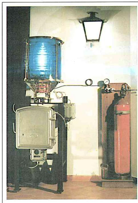
2.3.- Instalación del faro del puerto de Palma que prestó servicio de 1903 a 1951 con una lámpara Maris, electrificándose en 1951. Se retiró en 1982 con el destellador incorporado para reserva de gas.
