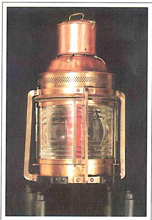
3.3.- linterna BBT con óptica del faro del puerto de Palma que prestó servicio entre 1890 y 1903 con luz fija roja.
