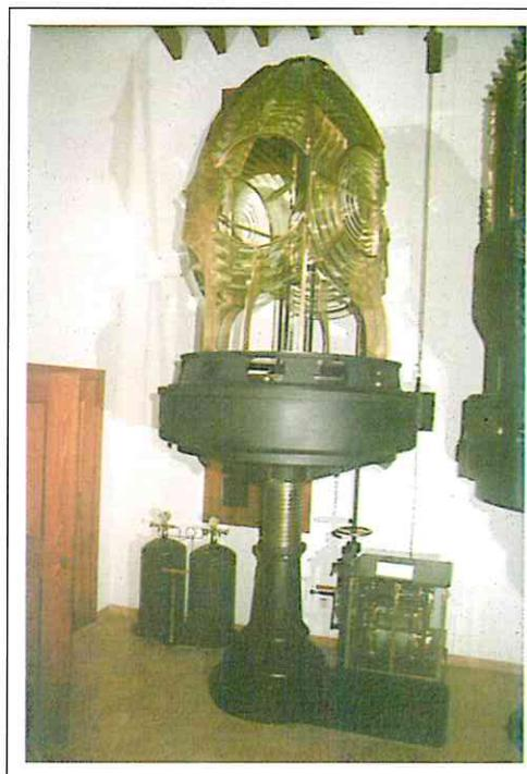
2.7.- Basamento con cuba de mercurio, máquina de rotación y óptica giratoria que prestó servicio en el faro de Favàritx entre 1922 y 1970. Fué la primera instalación de este faro relativamente moderno.
