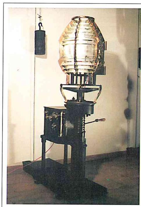
2.1.- Basamento y máquina de rotación que prestaron servicio en el faro del puerto de Palma entre 1903 y 1951. La óptica procede de la antigua instalación del faro de Porto Pí que prestó servicio entre 1892 y 1927.
