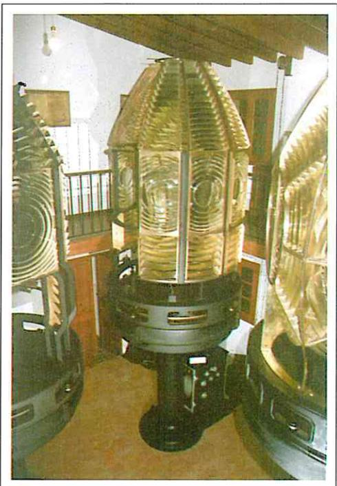
2.8.- Basamento con cuba de mercurio, máquina de rotación y óptica giratoria procedentes del faro de n'Ensiola. Prestó servicio, con una instalación Chance de vapor de petróleo, entre 1927 y 1971. Fué la segunda.
