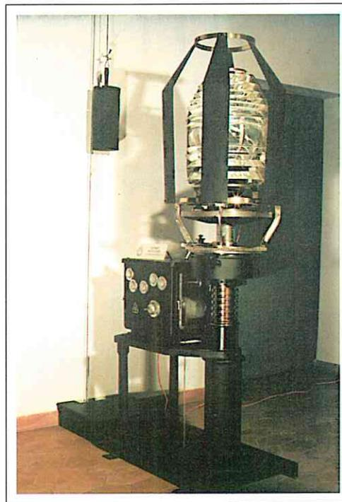
2.5.- Basamento y máquina de rotación procedente del antiguo faro de l'illa d'Alcanada en servicio entre 1922 y 1959; la óptica procede del faro de Conillera.
