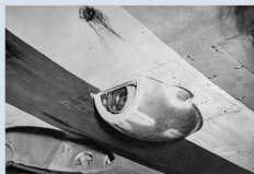
Càmera F24 en posició obliqua sota les ales d'un Supermarine Spitfire. ©RMM (C 5472)
